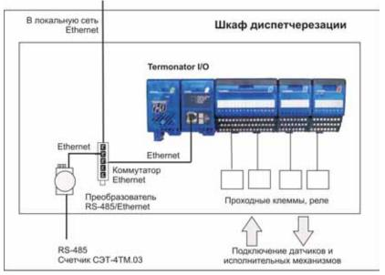
Оптоволоконная сеть объединяет 24 шкафа диспетчеризации, 5 из которых установлены на территории завода. Шкафы диспетчеризации построены по единой структуре (рис. 2). Такая структура позволяет вносить изменения и дополнять систему при вводе новых объектов увеличением модулей ввода/вывода и добавлением шкафов диспетчеризации.
